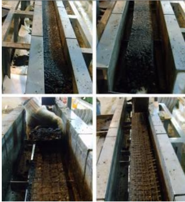
Рисунок Б VI.2 – Процесс извлечения геосетки из конструкции
